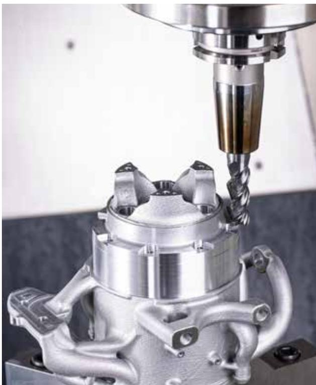
Fräsen von zylindrischen Flächen mit dem Frässystem DS.
