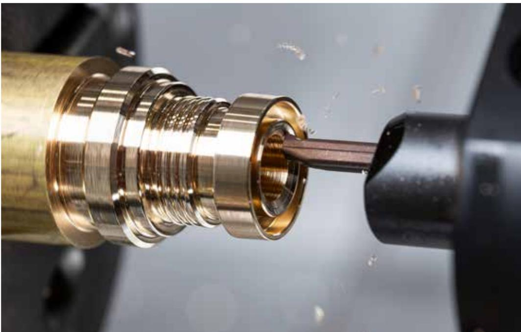
Das System Supermini mit gesinterter Spanformgeometrie überzeugt durch eine hohe Spankontrolle.
