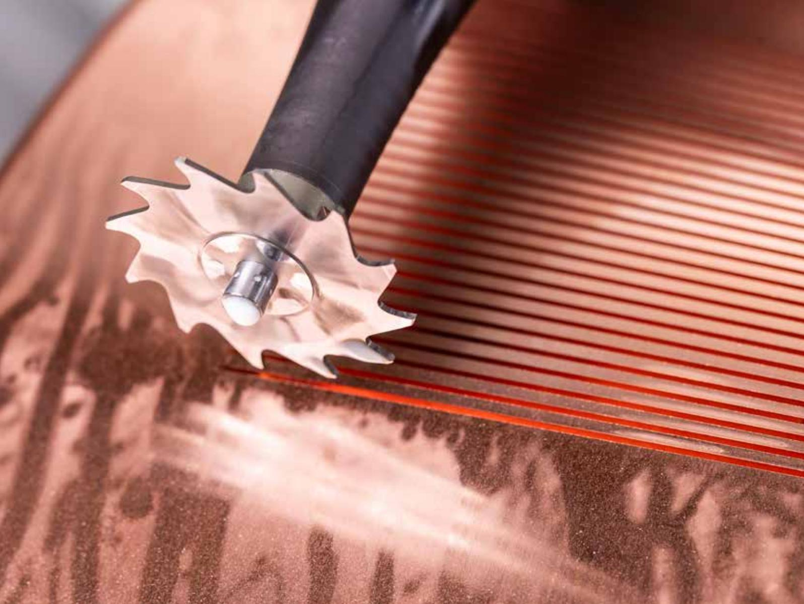
Die innere Kühlmittelzufuhr leitet den KSS an beide Flanken der Schneiden. Dies ermöglicht, neben der hohen Präzision und Standzeit, das Ausspülen der Späne aus den schmalen Nuten.
