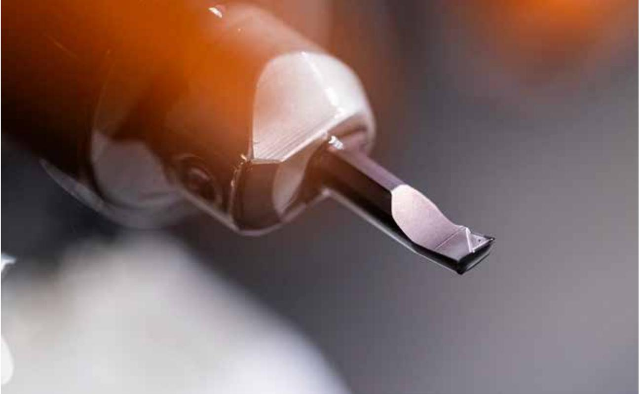
Die gesinterte Spanformgeometrie löste das Problem mit dem Spänestau.
