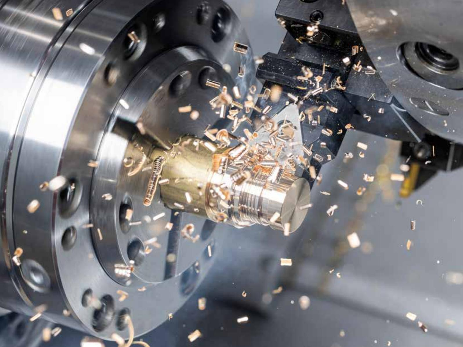
Angepasste Schneidengeometrien schaffen bei der Zerspaltung von bleifreien Werkstoffen ein hohes Maß an Prozesssicherheit.
