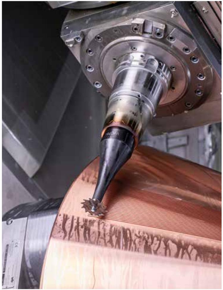
Der massiv ausgeführte Werkzeuggrundträger aus Stahl ist eine feingewichtete Aufnahme geschruppft. Somit ist die vibrationsarme Bearbeitung trotz der langen Auskrägung sichergestellt.
