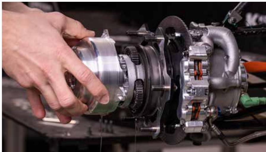
Einer der größten Knackpunkte für die Fertigung der mechanischen Komponenten sind die vier Radträger.
