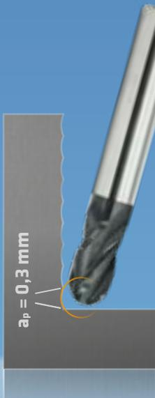
Kugelfräser: Der kleine Eingriffsbereich erfordert viele Bearbeitungsbahnen (Zeilensprünge), um die geforderte Oberflächenrauheit zu erreichen.
