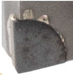
Gelaserte PKD-Schneidstoffe für den Hochleistungseinsatz.
