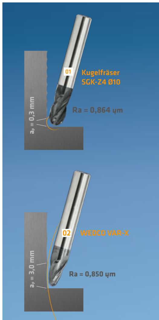
Bei gleicher theoretischer Rautiefe bieten die VAR-X-Fräser bis zu 10-fach höhere Zeilensprünge und dadurch geringere Bearbeitungszeiten.
