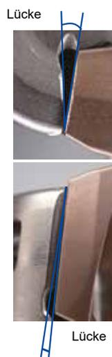
\*Bei der Montage von Schneidplatten mit einem Eckenradius von  $\geq 3,0$  mm ist eine Modifikation des Fräskörpers erforderlich.
