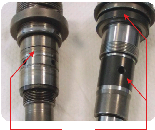
Benutzte Welle vom Wettbewerb ohne Keramikbeschichtung
